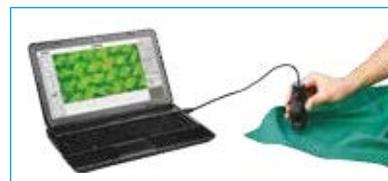
mettere il microscopio digitale direttamente sul pezzo per ispezione e misurazione
